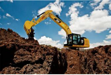
Kettenbagger CAT 320EL (21,8 t) von Caterpillar
