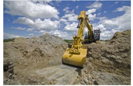
Kettenbagger CAT 323EL CGC (22,8 t) von Caterpillar
